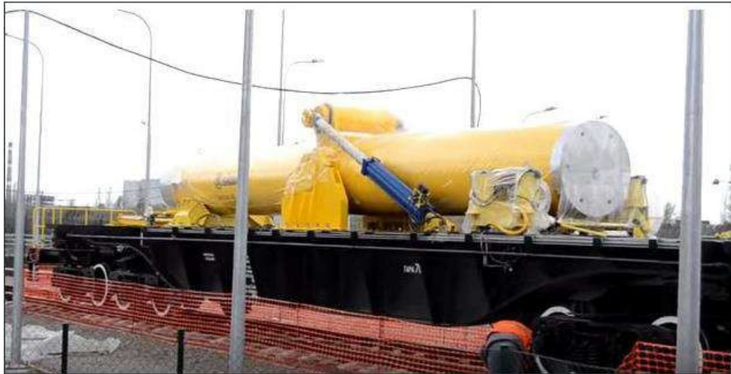
Рисунок 4.12 – Герметичний вагон-контейнер для перевезення ВЯП
