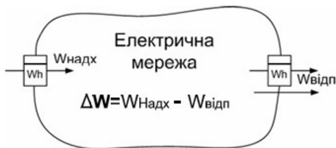
Рисунок 1 – Баланс електроенергії в електричних мережах
